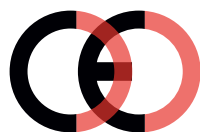
Marcatura CE contraffatta (troppo vicino)
